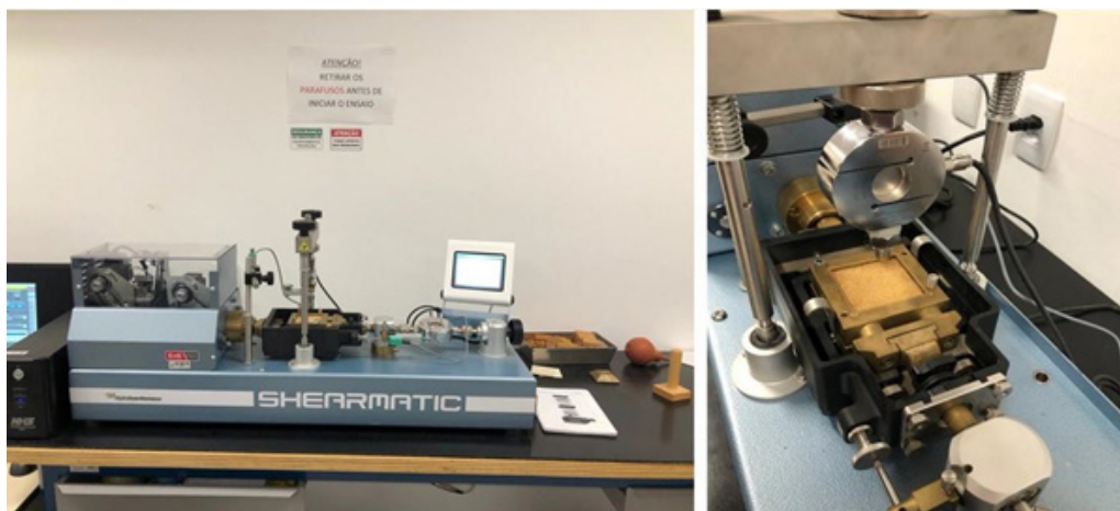
Figura 4 – Equipamento de cisalhamento direto (Shearmatic, fabricado pela Controls – Wykehan Ferrance), disposto no Laboratório de Mecânica dos Solos do Centro Universitário Serra dos Órgãos (UNIFESO), em Teresópolis/RJ.
