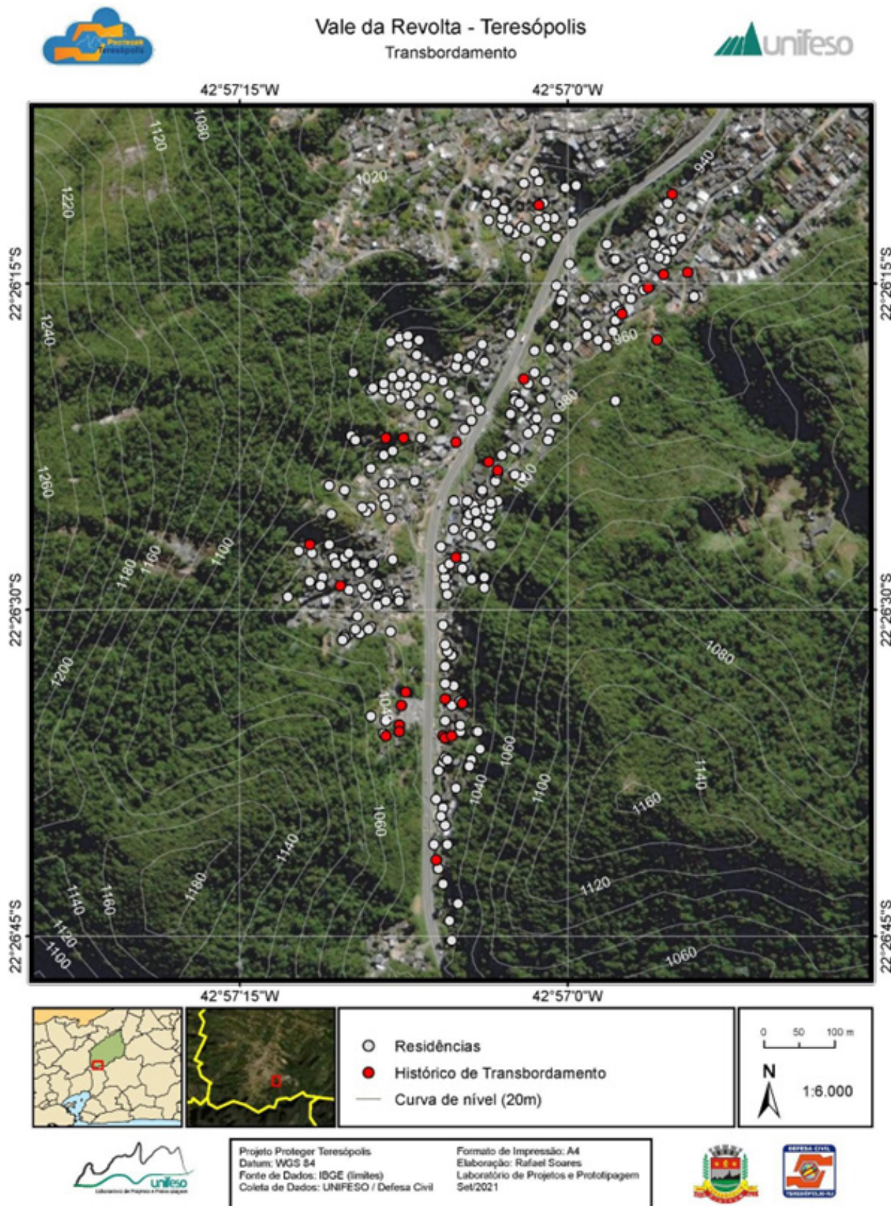
Figura 7 – Índícios de transbordamento das caixas d’água das residências avaliadas no Vale da Revolta – Teresópolis/RJ.
