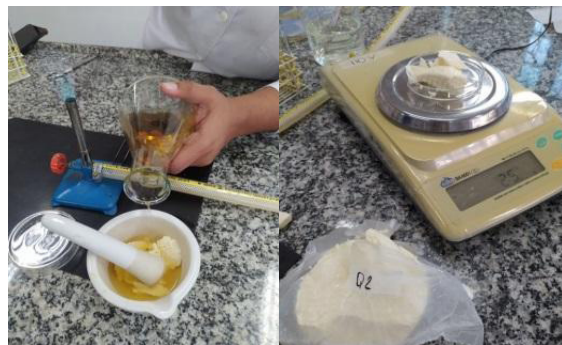
Figura 2 - A: pesagem da amostra para diluição; B: fragmentação da amostra a ser transferida para o Erlenmeyer na zona de segurança
