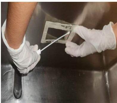
Figura 1 – Coleta da amostra do tanque utilizando swab para transporte e molde 5 x 10 cm
