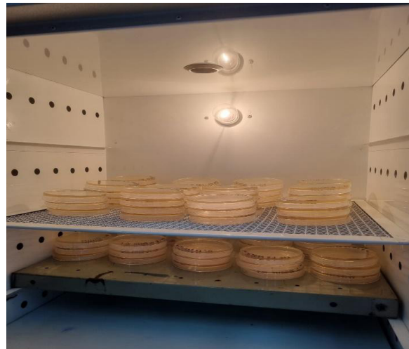
Figura 2 – Placas de Baird Parker inoculadas com as diluições 10-1 a 10-6 das amostras invertidas, em duplicata, em incubação na estufa bacteriológica a 37°C
