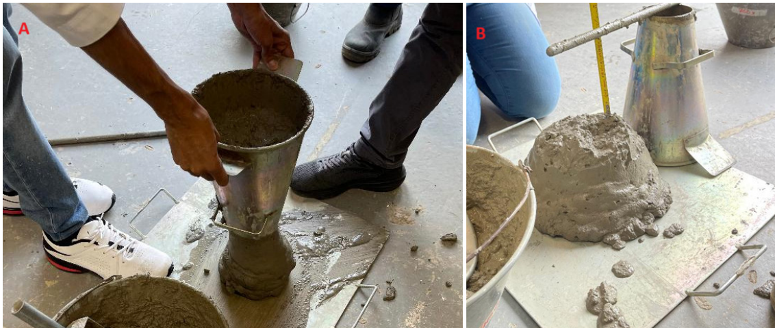
Fig. 3: Slump Test : (A) Abatimento do concreto; (B) Desmolde do ensaio de abatimento.
