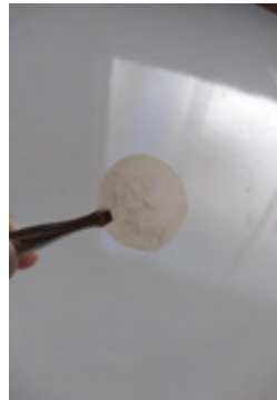
Figura 8: Celulose purificada em hidrólise e seca
