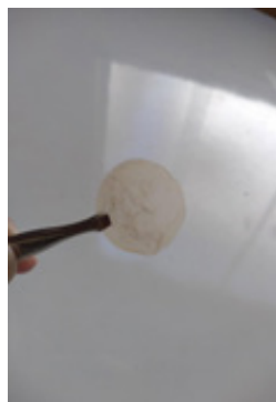
Figura 8: Celulose purificada em hidrólise e seca
