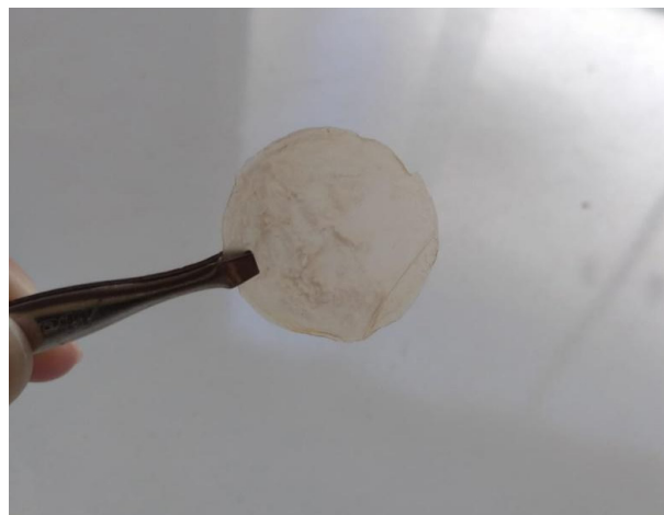
Figura 8: Celulose purificada em hidrólise e seca
