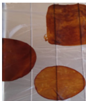
Figura 7: Celuloses Purificada em hidrólise alcalina durante a secagem
