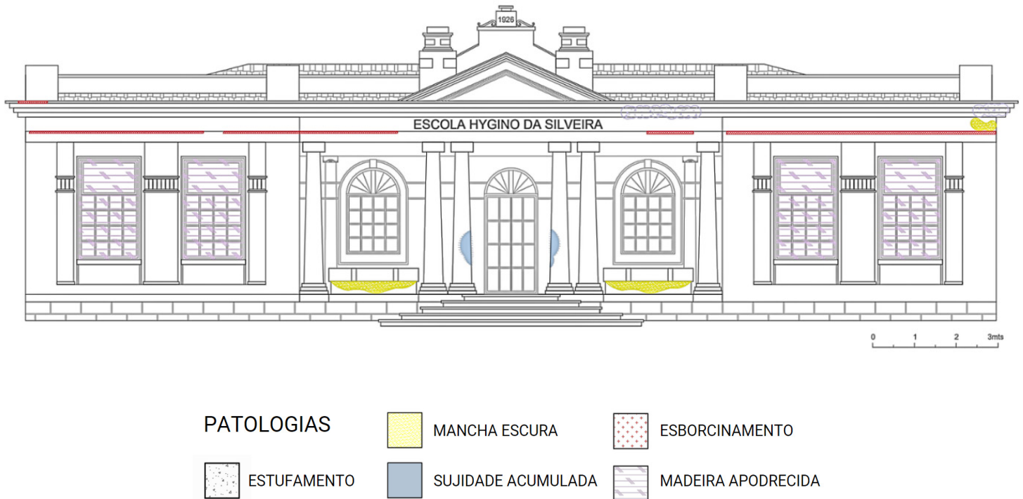
Figura 4- Mapeamento de danos Higino da Silveira
