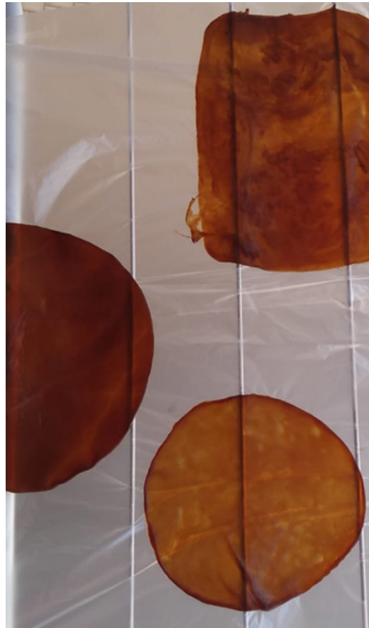
Figura 8: Celulose purificada em hidrólise e seca
