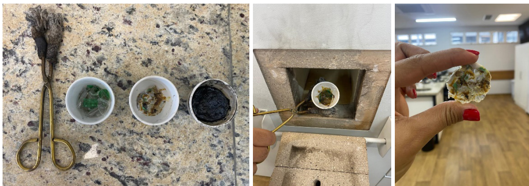
Figura 8. PET em diferentes condições antes e após ser levado à mufla (alto-forno).
