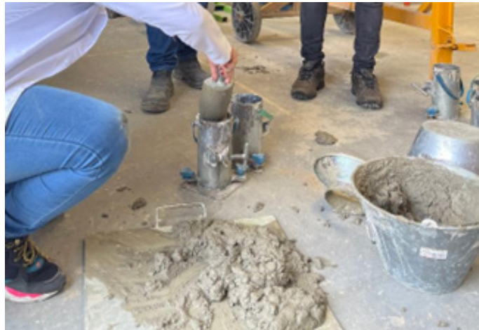
Fig. 1: Preparo dos corpos de prova dos compósitos EPS/Concreto.
