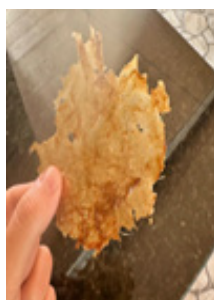
Figura 10: Peças de celulose reconstruídas pós secagem em tela de serigrafia
