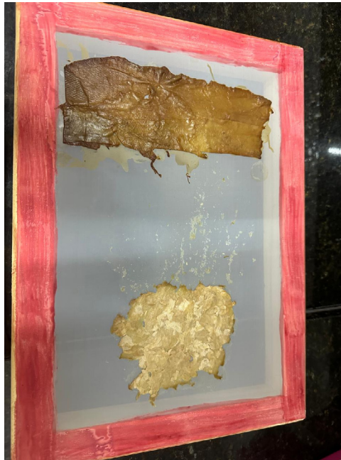
Figura 10: Peças de celulose reconstituídas após a secagem
