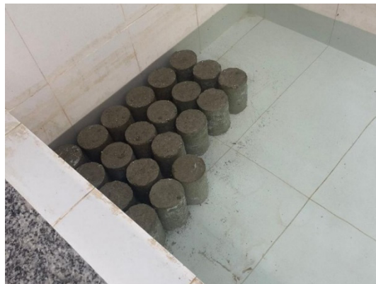
Fig. 2: Cura úmida dos corpos de prova em imersão de tanque com água.
