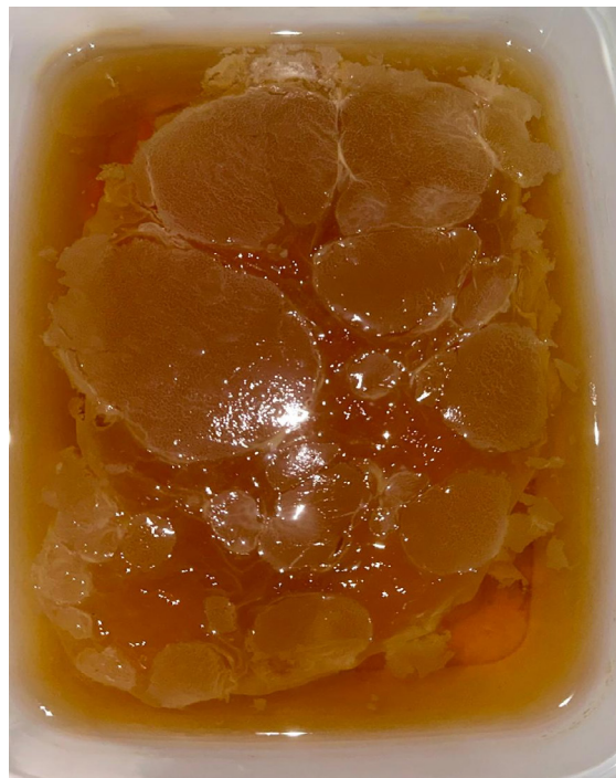
Figura 4: Delicada película de celulose cultivada em meio água com açúcar.
