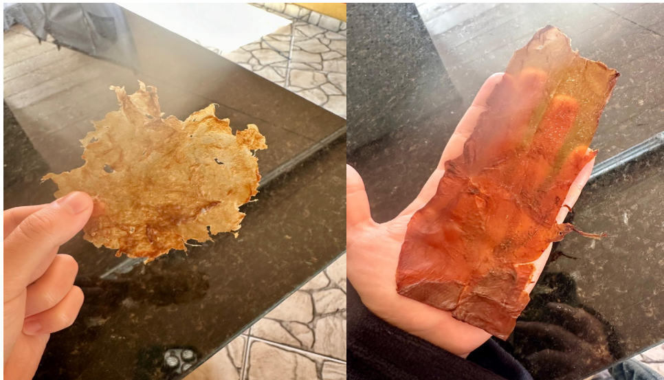
Figura 10: Peças de celulose reconstituídas após a secagem
