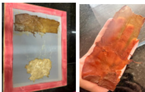
Figura 10: Peças de celulose reconstruídas pós secagem em tela de serigrafia
